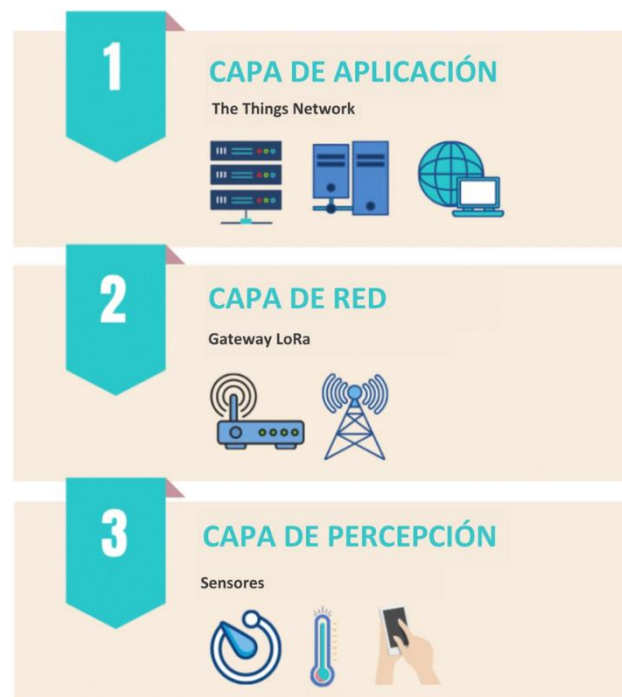
Figura 7. Arquitectura de red de 3 capas de sensores ambientales utilizando la tecnología LoRaWAN
