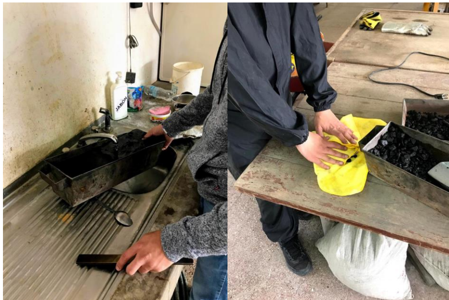
Figura 4.4. Realización de ensayo de gravedad específica de agregado grueso
