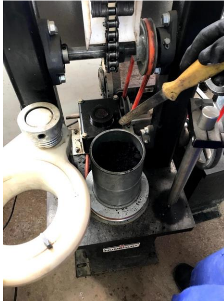
Figura 5.11. Proceso de compactación manual
