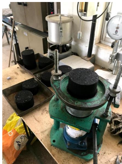
Figura 5.13. Desmolde de briquetas
