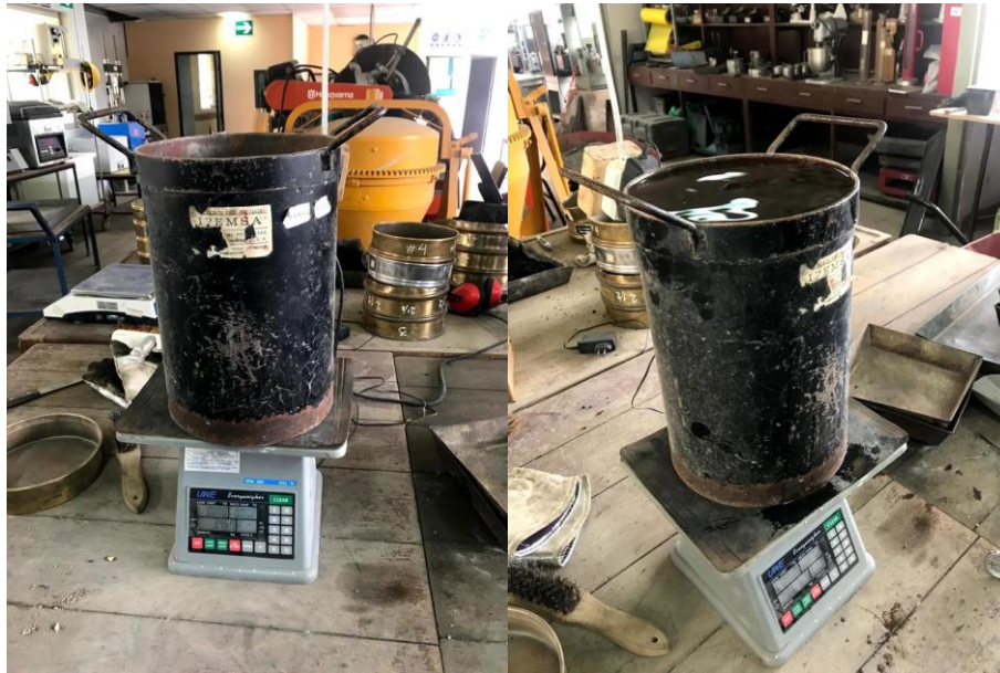
Figura 4.9. Realización de ensayo de peso unitario
