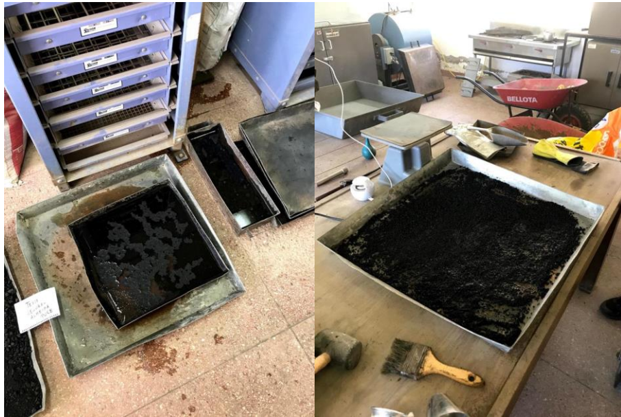
Figura 4.6. Realización de ensayo de gravedad específica de agregado fino
