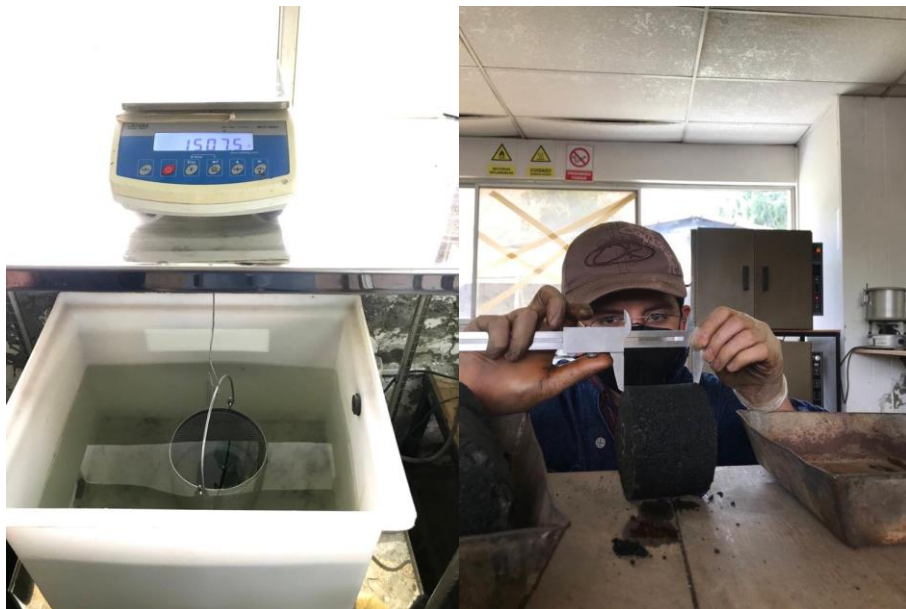
Figura 5.16. Obtención de peso sumergido (izquierda) y volumen de briqueta (derecha)
