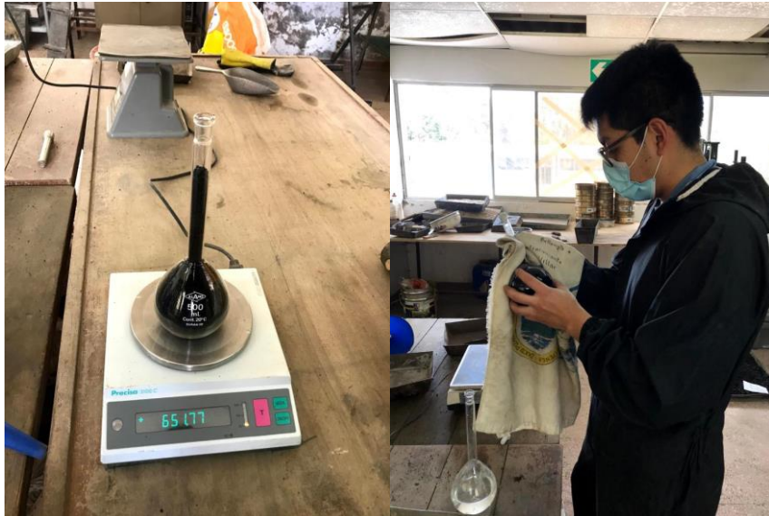
Figura 4.8. Realización de ensayo de gravedad específica de agregado fino
