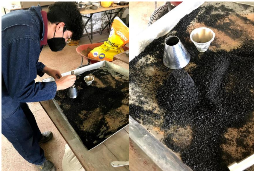
Figura 4.7. Realización de ensayo de gravedad específica de agregado fino
