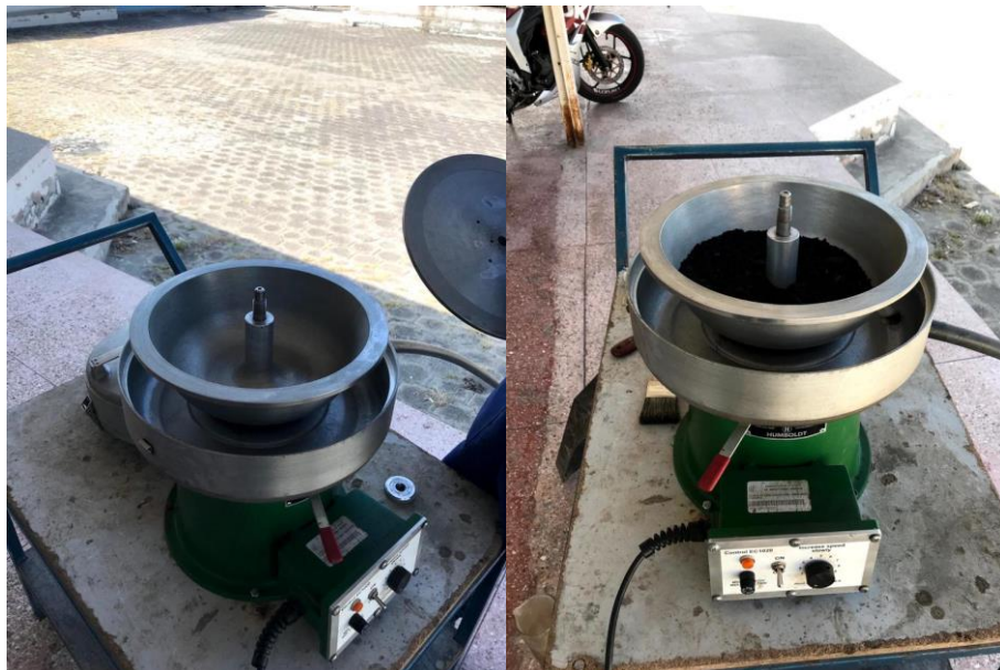
Figura 4.11. Realización de ensayo de asfalto residual
