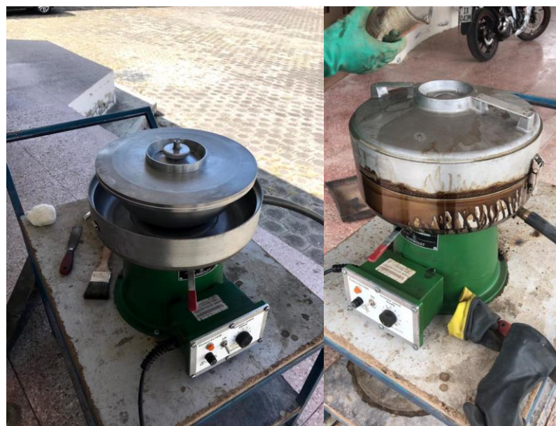
Figura 4.13. Realización de ensayo de asfalto residual
