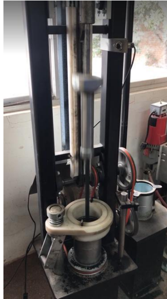
Figura 5.12. Proceso de compactación mecánica
