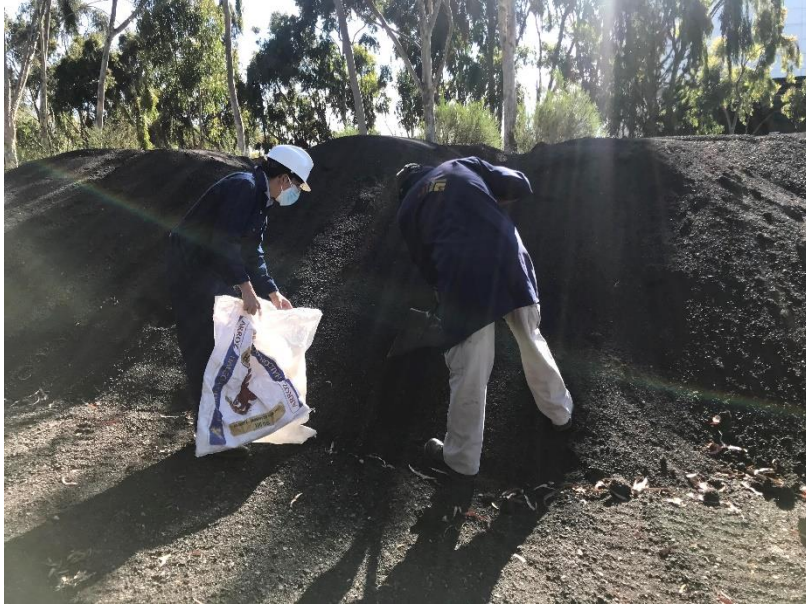
Figura 5.1. Obtención de muestra representativa
