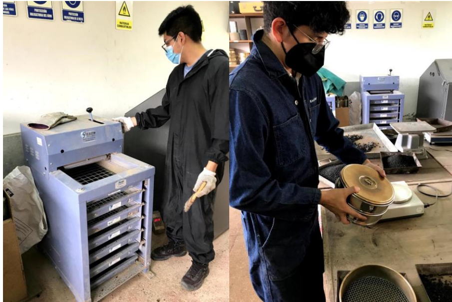
Figura 4.1. Realización de ensayo de granulometría
