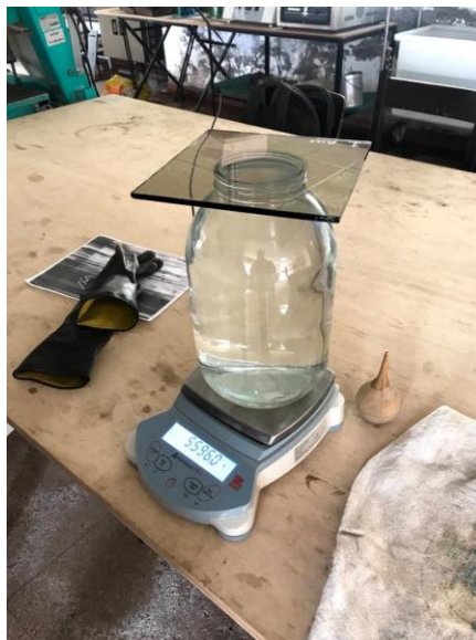
Figura 5.4. Calibración del recipiente
