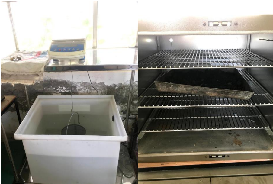
Figura 4.5. Realización de ensayo de gravedad específica de agregado grueso
