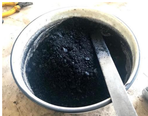
Figura 5.9. Mezcla lista para realización de briquetas
