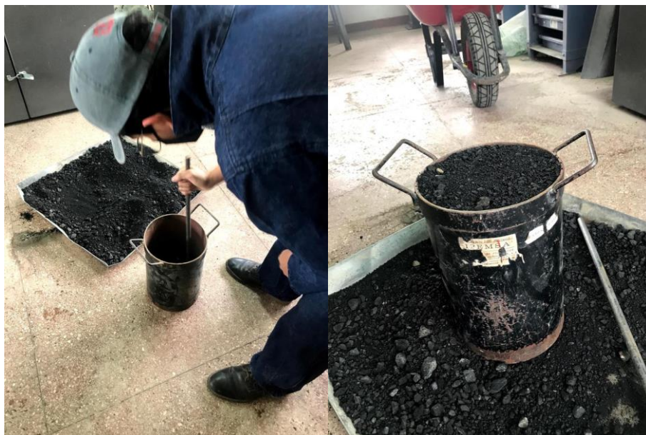
Figura 4.10. Realización de ensayo de peso unitario
