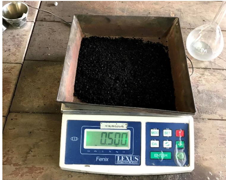
Figura 5.2. Peso de muestra representativa
