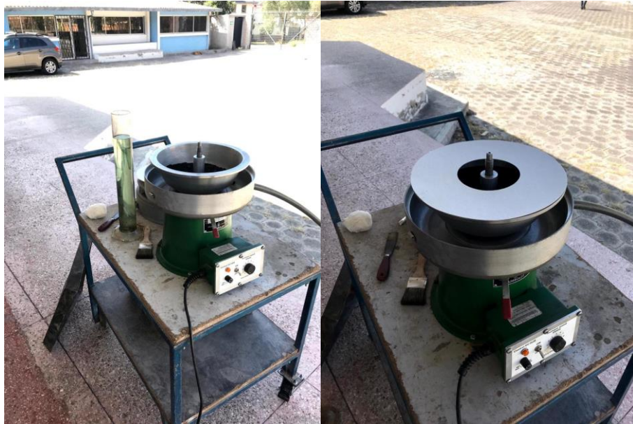
Figura 4.12. Realización de ensayo de asfalto residual
