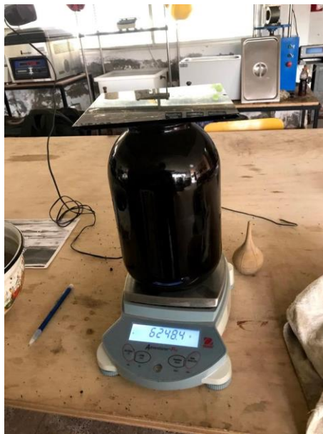
Figura 5.7. Peso de frasco + agua + mezcla + tapa de vidrio
