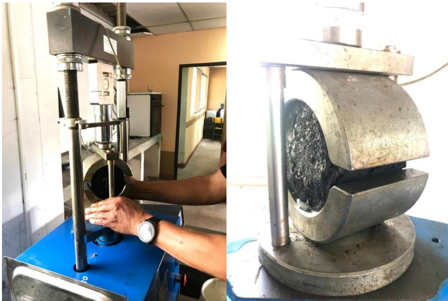
Figura 5.18. Rotura de briquetas
