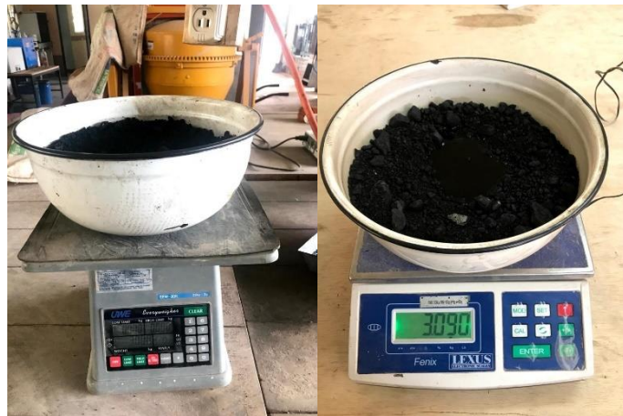
Figura 5.8. Preparación de mezcla (material reciclado + emulsión)
