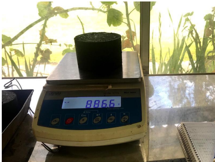
Figura 5.14. Peso seco de briqueta
