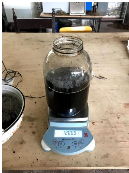
Figura 5.6. Colocación de 1200 g de mezcla en frasco
