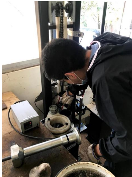
Figura 5.10. Colocación de aceite en tambor, martillo y molde
