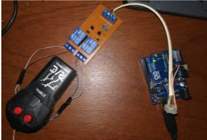
Figura 23. Circuito y conexión del controlador
