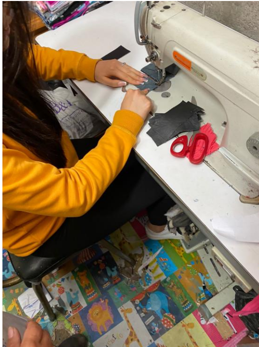
Figura 71. Corte y unión de los retazos en maquina recta
