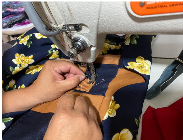
Figura 74. Colocación del arnés
