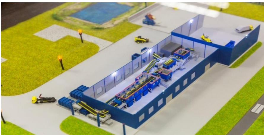
Gráfico 8. Modelo de ensamble de Planta de Clasificación de RSU
