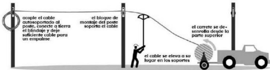
FIGURA 32. MONTAJE DE FIBRA ÓPTICA MÉTODO DE ENROLLAMIENTO MÓVIL. [FUENTE: HTTP://WWW.CONECTRONICA.COM/FIBRA-OPTICA/CURSO-FIBRA-OPTICA/TIPOS-DE-INSTALACION-DE-FIBRA-OPTICA ]
