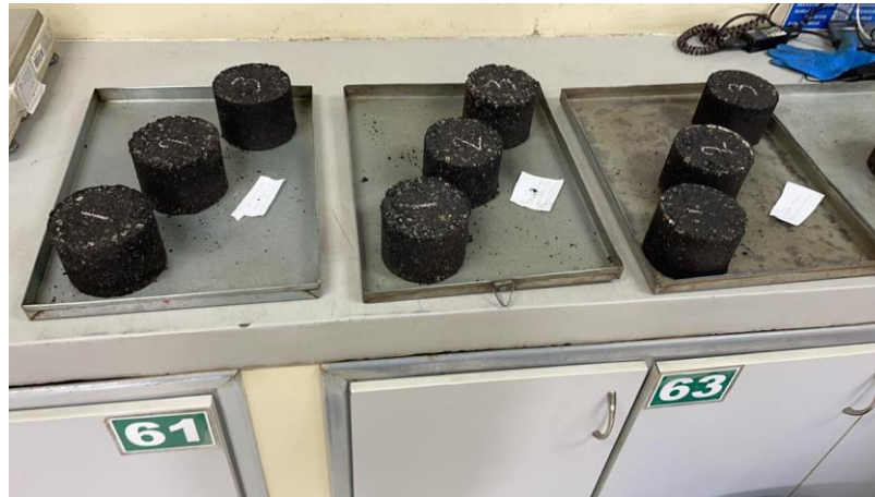
Fotografía 4. 6 Briquetas mezcla tradicional, 2 y 3 % de celulosa para realizar ensayos
