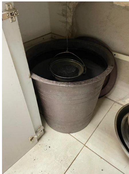
Fotografía 4. 7 Ensayos Densidad Bulk
