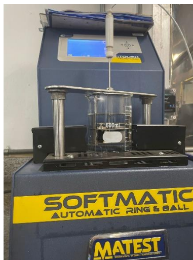
Fotografía 3. 12 Máquina Punto de Ablandamiento
