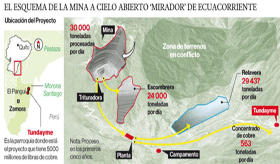
Figura 29: Esquema de la mina a cielo abierto “Mirador de Ecuacorriente”
