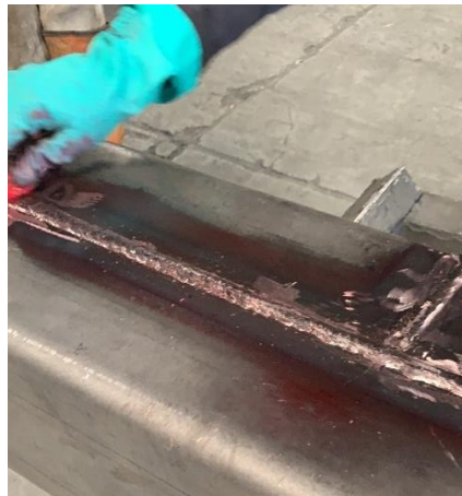
Ilustración 18: Remoción de tinta penetrante de superficie de ensayo.
