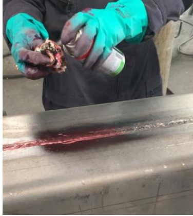
Ilustración 17: Aplicación de Removedor sobre Paño de Limpieza.
