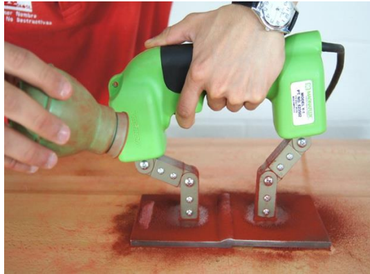
Ilustración 6: Magnetización de Partículas. (Ilog SA de CV, 2011)
