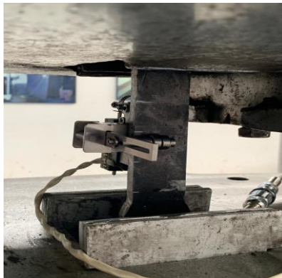
Ilustración 10: Tracción de probeta
