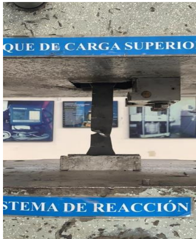
Ilustración 11: Rotura de probeta por tracción.
