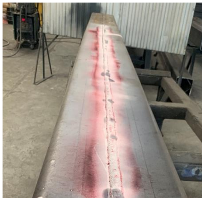
Ilustración 22: Secado de revelador .
