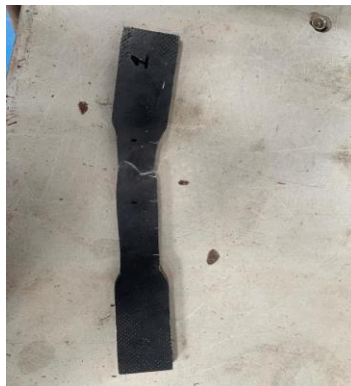
Ilustración 12: Probeta Rota por falla a la tracción.
