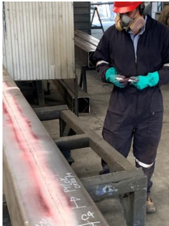
Ilustración 23: Revisión por parte de Inspector de ensayos de Soldadura
