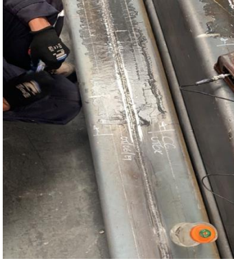
Ilustración 25: Colocación de Gel Metil Celulosa
