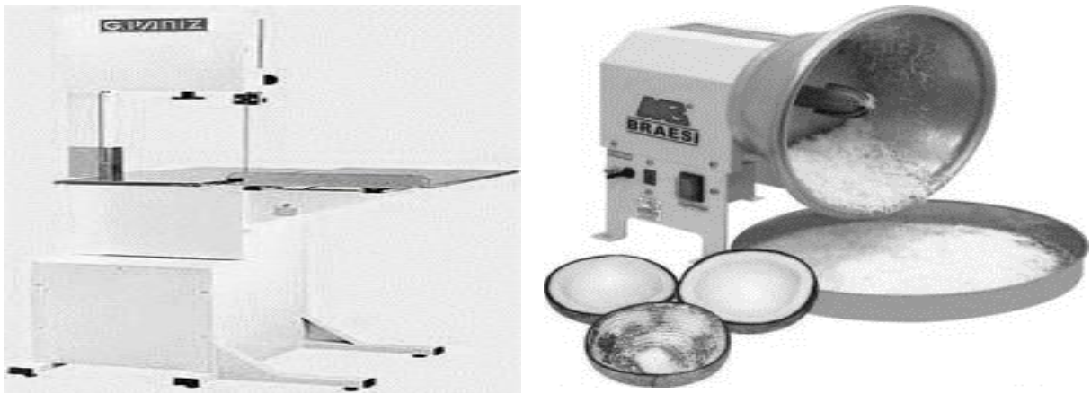
Figura 23. Equipo de Corte para Corteza y Extracción de Pulpa
