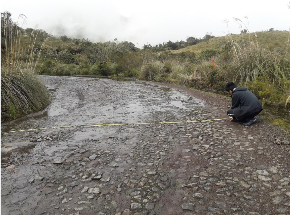
Ilustración 2 Medición de ancho de vía
