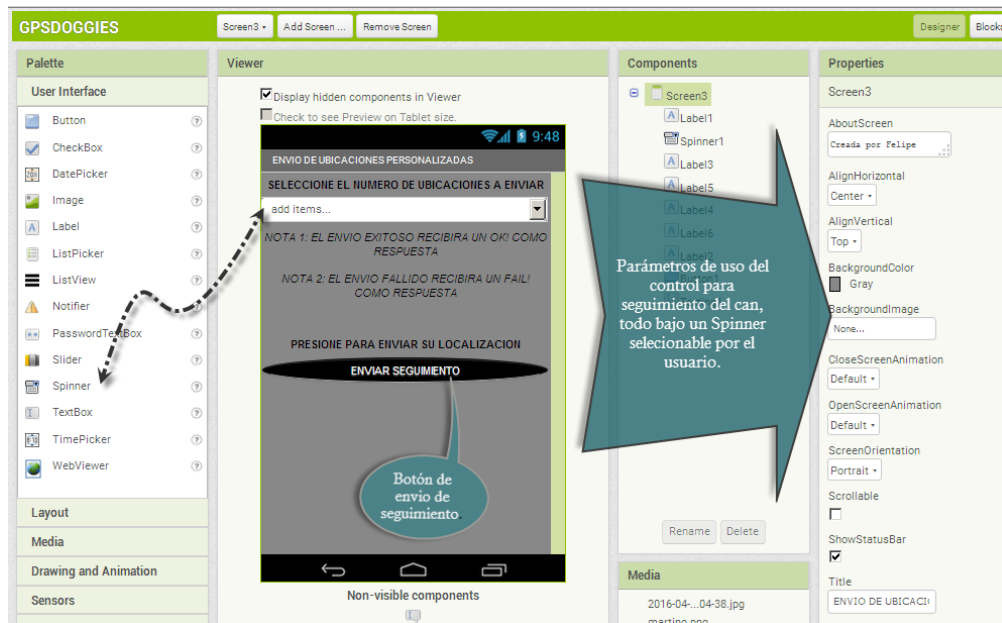
Figura 52. Entorno de programación y código usado en la parte Designer de la Pantalla Tres. (Basantes, 2016, pp. 72).
