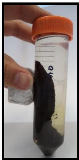
Figura 3.7. Nanopartículas de magnetita recubiertas con quitosano expuestas a un campo magnético externo
