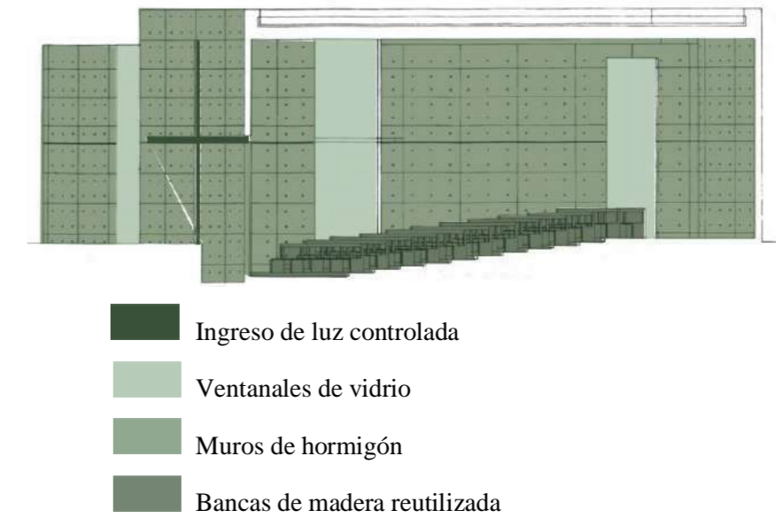
Figura 22: Diagrama de materialidad en corte, Iglesia de la luz. Elaboración propia (2022)
