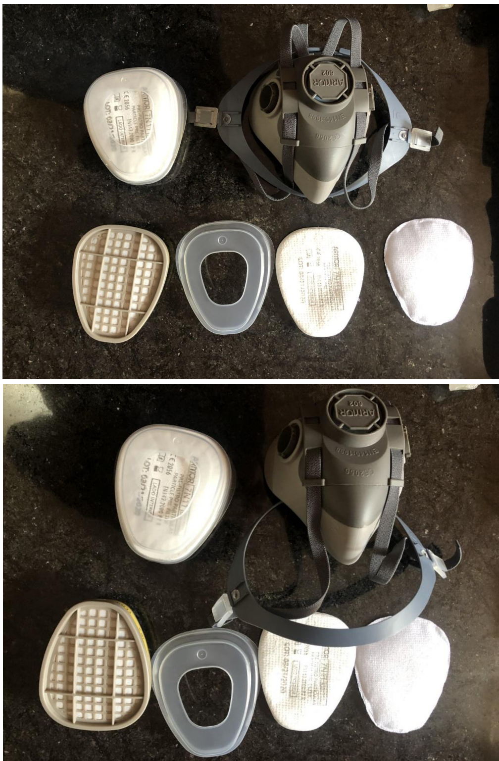
Figura . 11 Sistema de filtrado de acople
