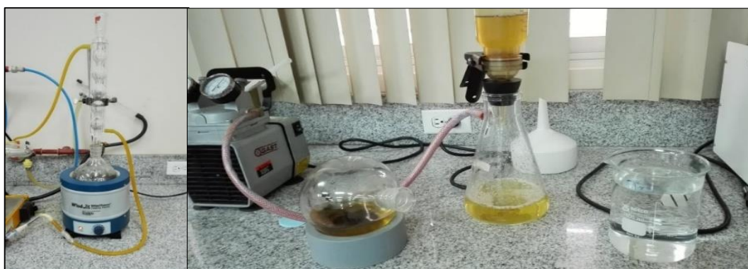
Figura 14. Manta calefactora y bomba de vacío.
