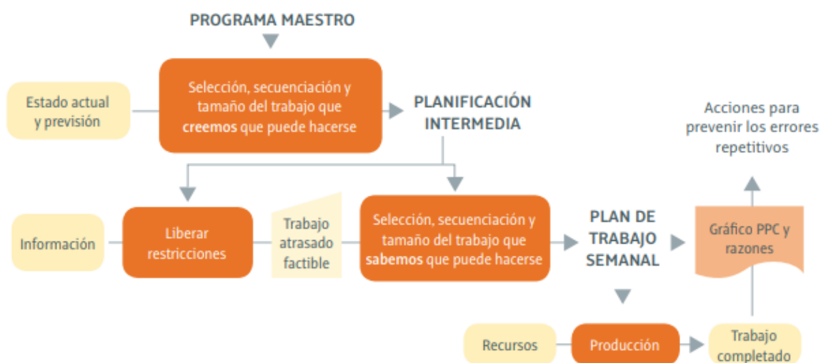
Ilustración 13: Modelo de planificación según LEAN CONSTRUCTION
