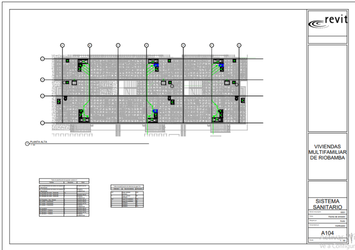
Figura 75. Plano MEP Hidrosanitario, Sanitario, Planta alta
