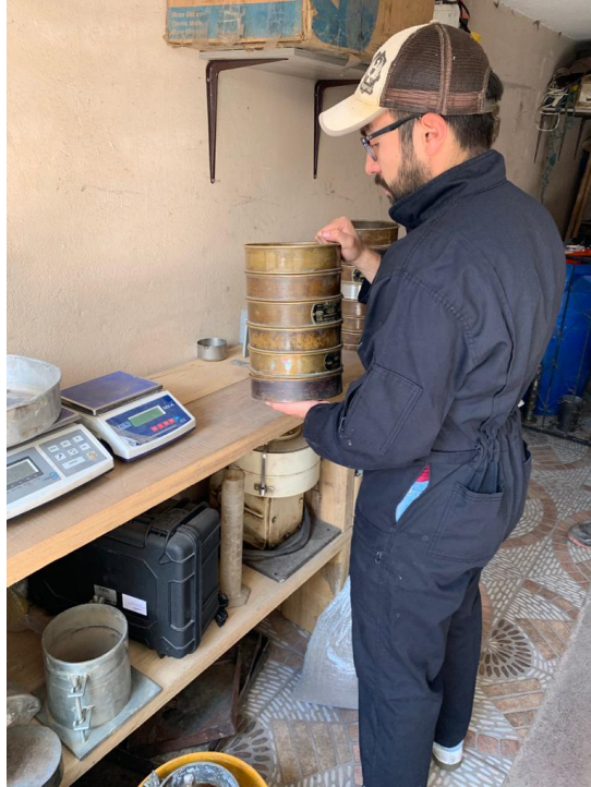
Ilustración 8.5 : Tamizado de Material. Fuente: Andrés Burgos.
