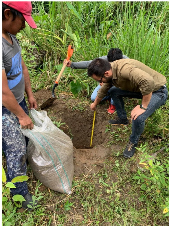
Ilustración 8.4 23: Excavación de Calicata a 0.50m de Profundidad. Fuente: Andrés Burgos.
