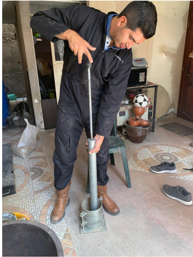
Ilustración 8.11 : Proctor Modificado. Fuente: Gerardo Benalcázar.
