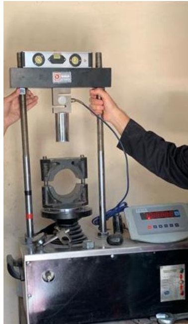
Ilustración 1.4: Máquina para Ensayos de CBR con Indicador Digital. Fuente: Andrés Burgos.
