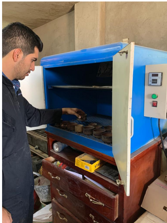
Ilustración 8.12 : Secado de Muestras. Fuente: Gerardo Benalcázar.
