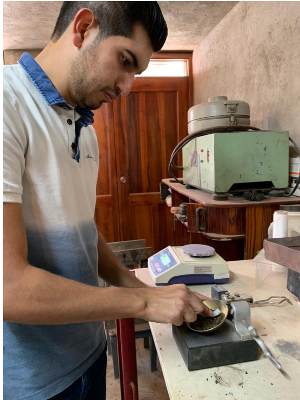
Ilustración 8.7 : Ensayo Copa de Casagrande. Fuente: Gerardo Benalcázar.
