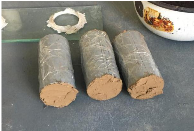
Figura N° 45: Muestras selladas con bentonita previa inyección.
