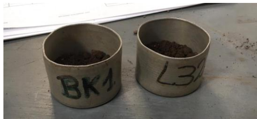
Figura N° 34: Toma de muestras para determinar las humedades.
