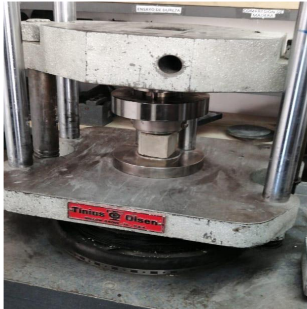
Figura N° 43: Proceso de rotura de cubo.
