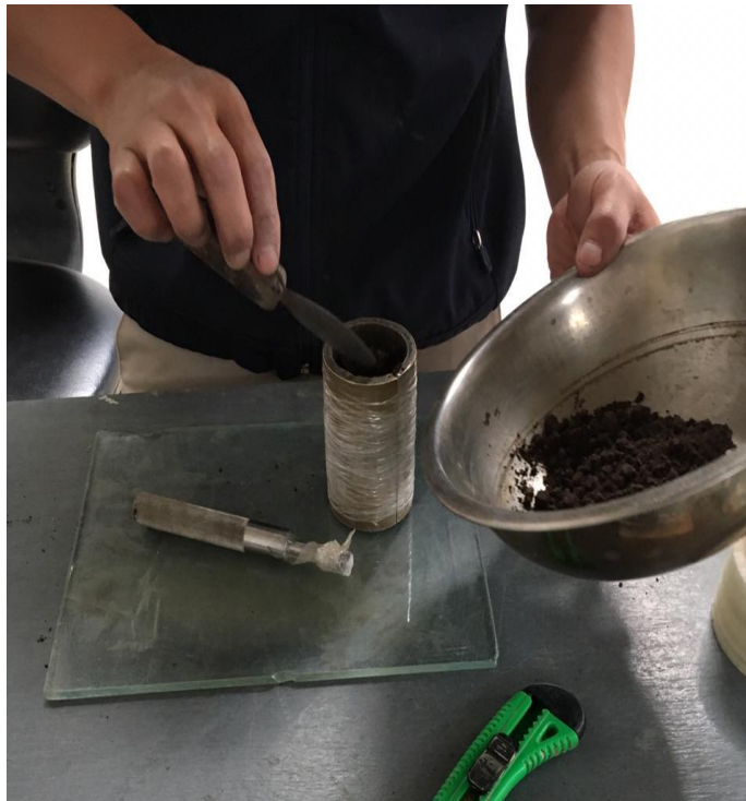
Figura N° 35: Remoldeo de las muestras previo al ensayo triaxial UU sin saturar.
