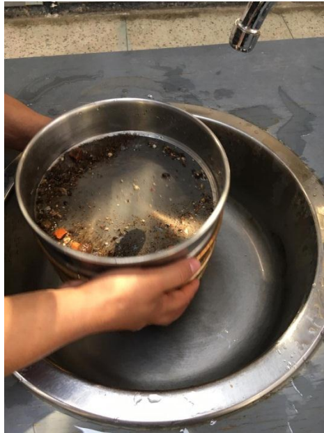
Figura N° 33: Tamizado para análisis granulométrico norma ASTM D 6913.
