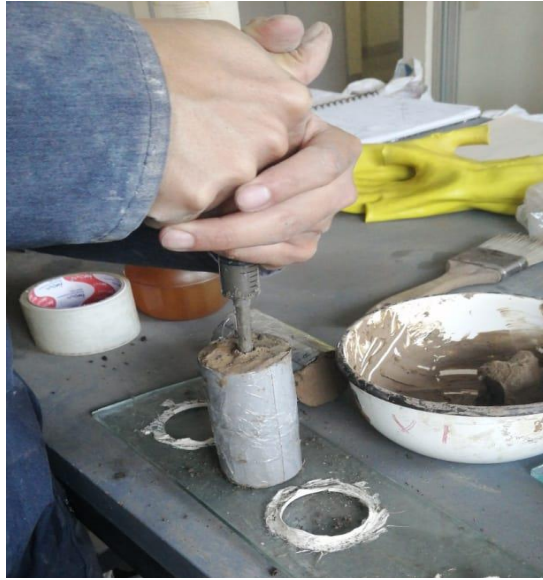
Figura N° 46: Emulación de inyección de la lechada
