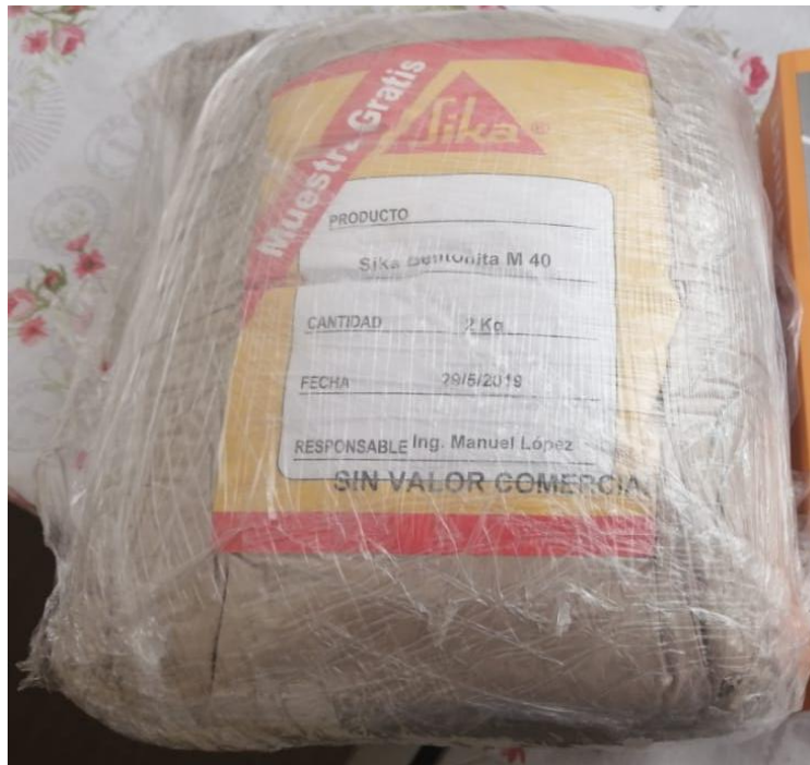
Figura N° 39: Bentonita Sika usada en la variación de mezclas.
