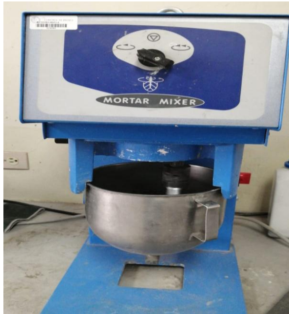
Figura N° 41: Proceso de mezclado de los elementos que conforman la lechada.
