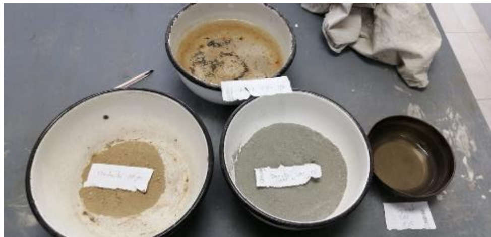
Figura N° 40: Dosificación al peso de bentonita, L65, N100 y cemento Selvalegre.
