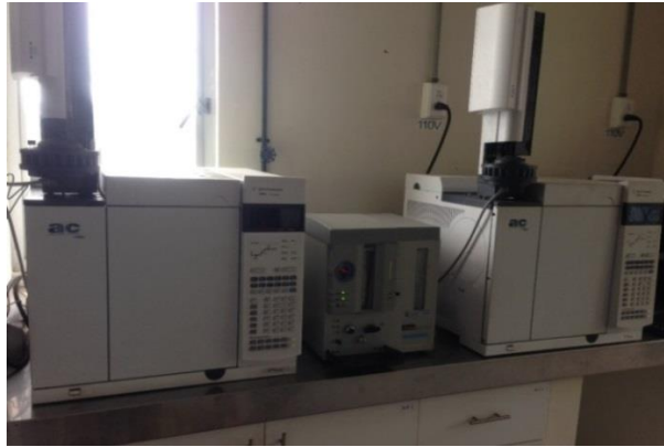
Figura 14. Equipo de destilación simulada ANALYTICAL CONTROLS aC.
