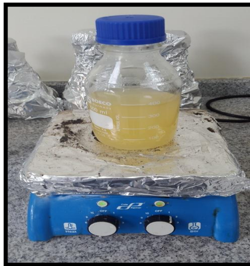
Fotografía 36: Agitador y calentador magnético Cole Parmer
