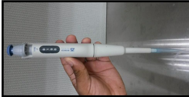
Fotografía31: Micro pipeta (BOECO Germany de 1000 \mu l)
