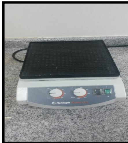
Fotografía32: Agitador (Heidolph Rotamax 120)
