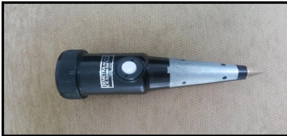
Fotografía 24: E.M. System Soil Testr para medir pH en sólidos
