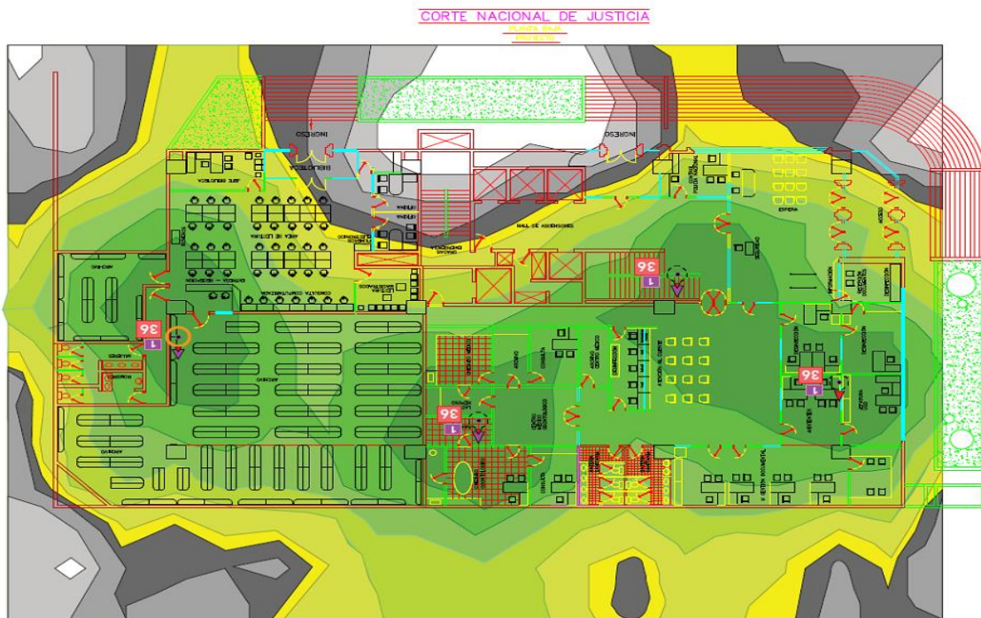
29 Figura. Mapa calor de equipos ubicados planta baja – CNJ, Airmagnet Planner
