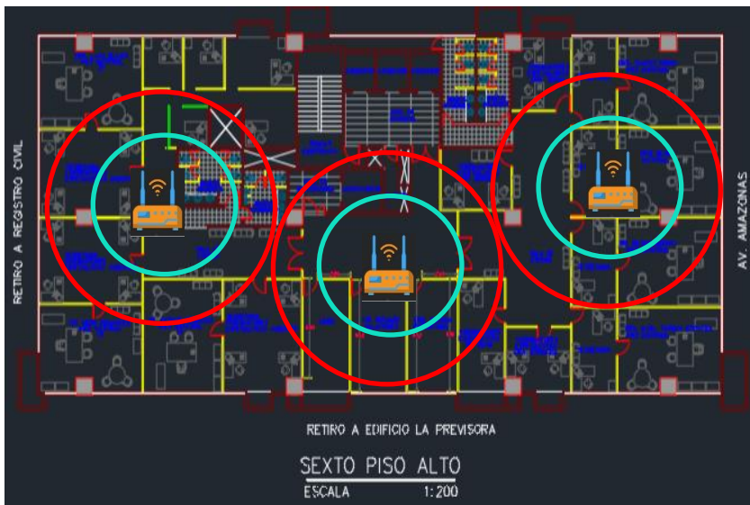
16 Figura. Ubicación de APs en Edificio CNJ sexto piso
