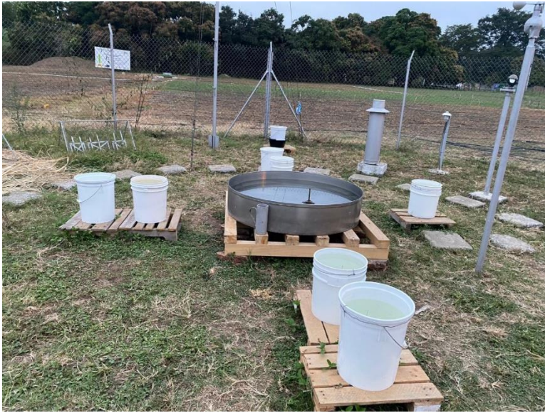
Ilustración 9 Terreno preparado con los tachos alrededor de la bandeja tipo A
