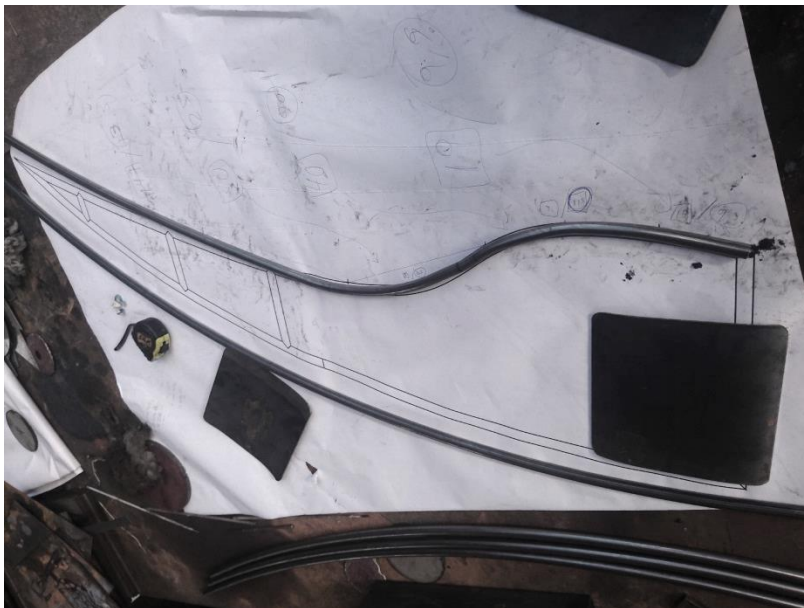
Figura 70. Comprobación de precisión de piezas y plantillas. Fuente elaboración propia.
