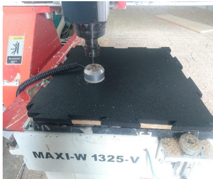
Figura 96. Calibración Router de corte en CNC. Fuente elaboración propia.
