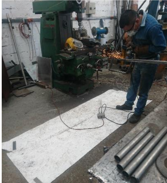
Figura 71. Soldadura y Pulido de piezas. Fuente elaboración propia.
