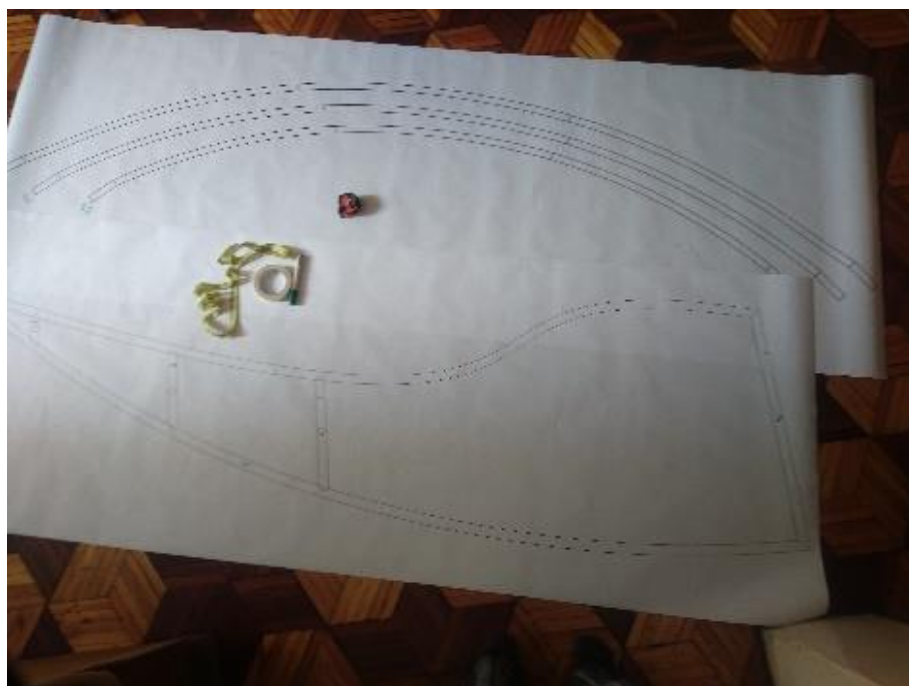
Figura 68. Matrices para corte y Barolado de columnas. Fuente elaboración propia.
