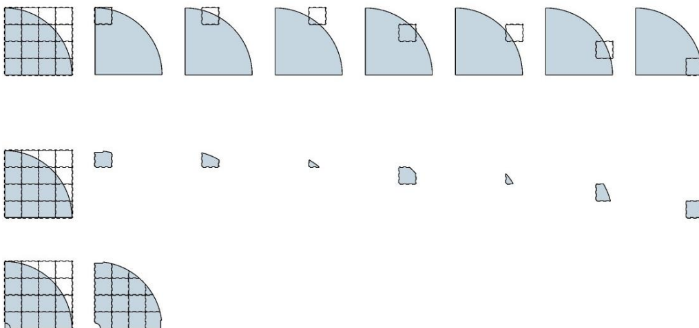
Figura 95. Captura Piso modular con planos de corte para CNC. Fuente elaboración propia.
