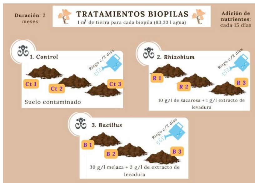
Figura 2. Diseño experimental con la distribución y composición de los tratamientos en fase de biopilas. Tiempo de duración, frecuencia de aplicación de tratamientos y riego.
