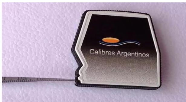
Fig. 9 Cinta métrica: Metálica, estrecha e inextensible (Homologada)
