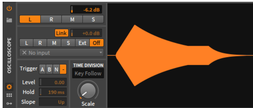
Figura 60. Prueba envolvente de amplitud - Attack: 400ms; Decay: 1000ms, Sustain: 0.4; Release: 900ms.
