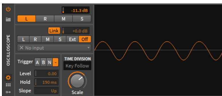
Figura 47. Prueba oscilador Maximillian generando onda sinusoidal. Elaboración propia.
