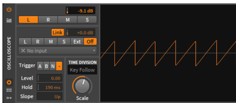
Figura 48. Prueba oscilador Maximillian generando onda sierra. Elaboración propia.
