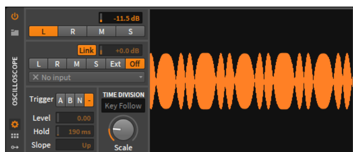
Figura 68. Prueba LFO - Frecuencia de la onda modulada, generando el efecto de vibrato. Elaboración propia.
