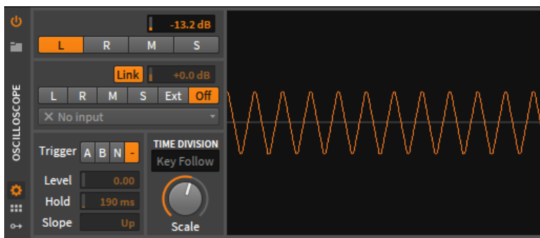
Figura 49. Prueba oscilador Maximillian generando onda triangular. Elaboración propia.
