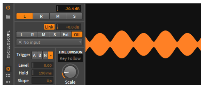
Figura 67. Prueba LFO – Amplitud de onda modulada, generando el efecto de tremolo. Elaboración propia.
