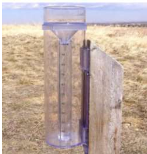
Figura 9. Pluviómetro de gama media Stratus 6330. Extraído del portal digital Equipamiento científico https://equipamientocientifico.com/shop/product/pluviometro-stratus-6330
