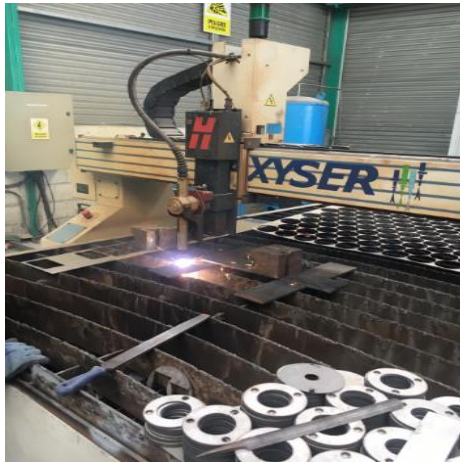
Figura 14: Maquina Industrial de Oxicorte, Empresa KUBIEC
