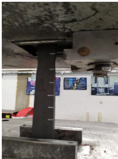
Figura 27: Proceso de deformación de la probeta
