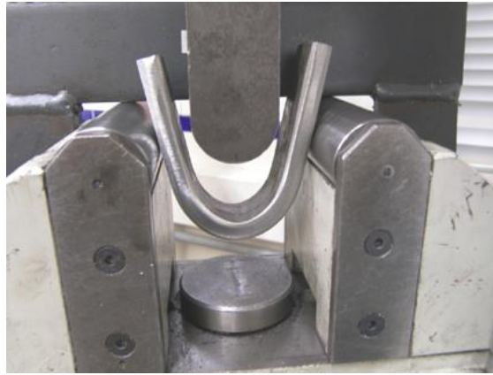
Figura 12: Ensayo de doblado del acero
