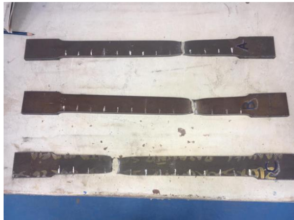
Figura 29: Muestras de acero fracturadas.
