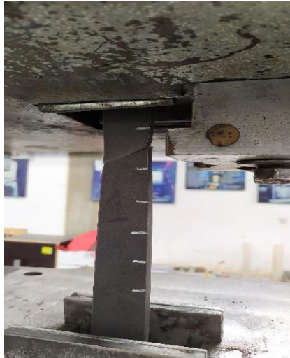
Figura 28: Ruptura o falla de la probeta
