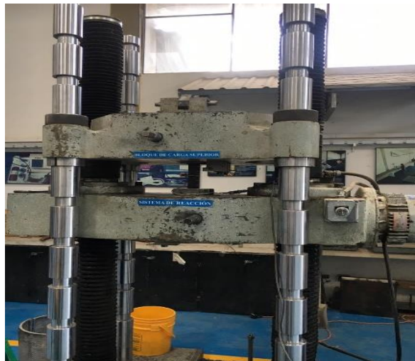
Figura 18: Máquina Universal de Ensayo, Laboratorio de materiales de la PUCE
