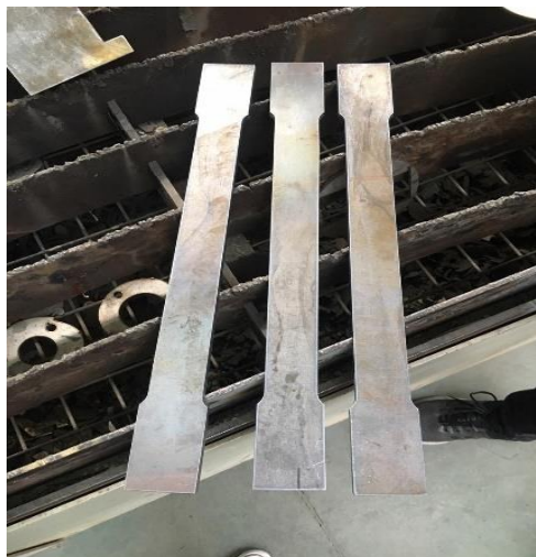
Figura 22: Probetas de acero, posterior al corte.
