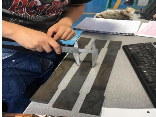
Figura 23: Toma de medidas (probetas de acero)
