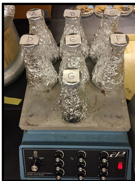
Figura 4. Dosis de iprodiona en frascos Erlenmeyer cubiertos con papel aluminio sobre un agitador magnético.
