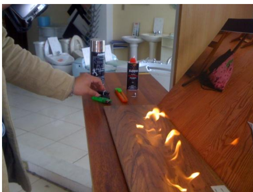
PRUEBA N°4: RESISTENCIA A PINTURAS Y QUÍMICOS
