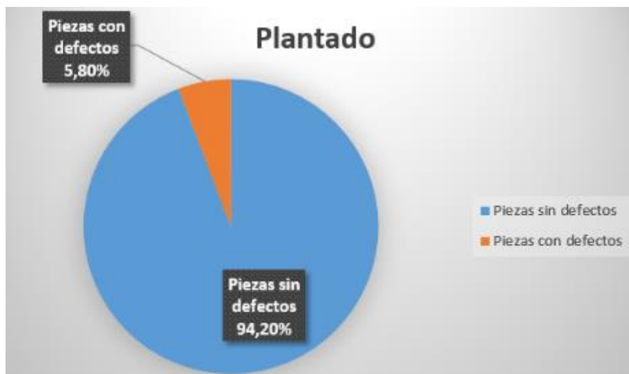
Gráfico 4.13: Resultados del proceso plantado en piezas
