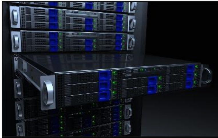
Ilustración 1.1-2 Servidores tipo Rack (Mera, 2015)
