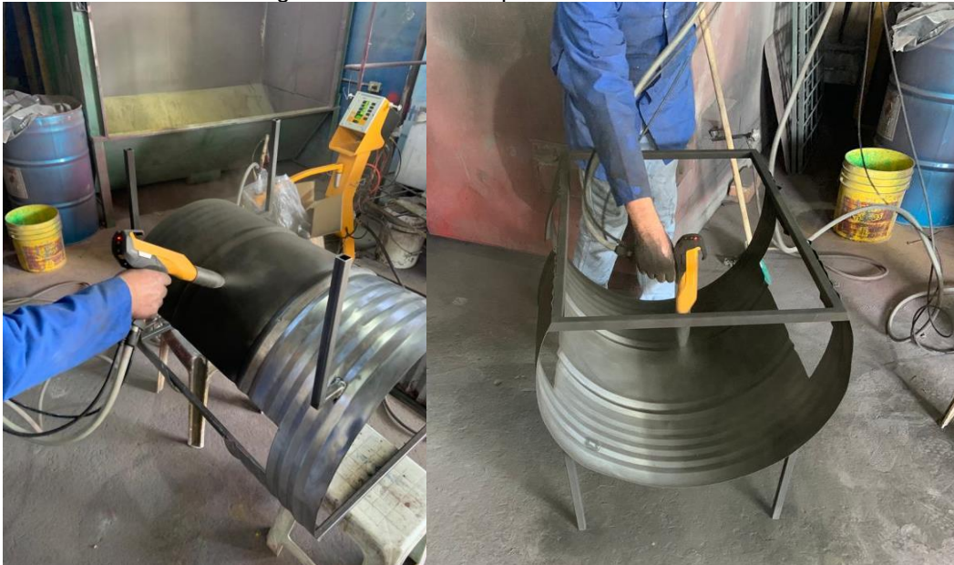
Figura 83. Proceso de pintado de la mesa
