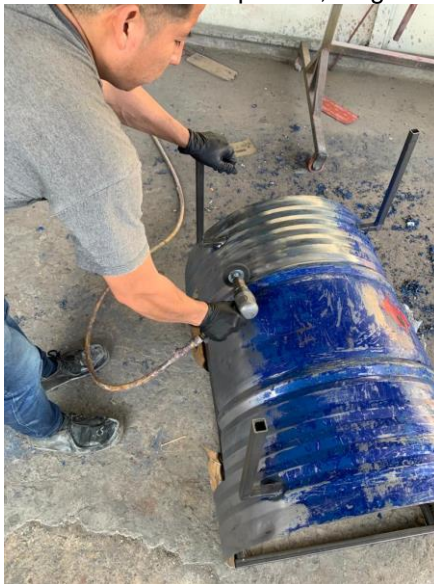
Figura 81. Proceso de sacar la pintura, luego del removedor
