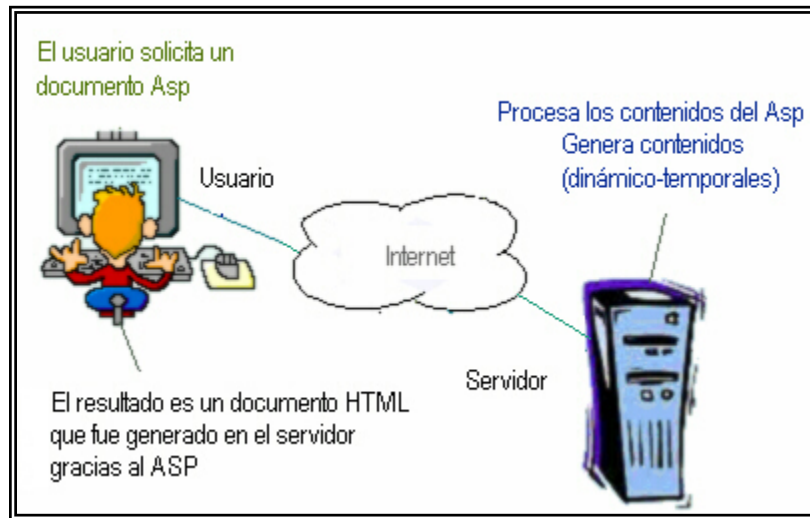
Figura 3.1: Funcionamiento del ASP
