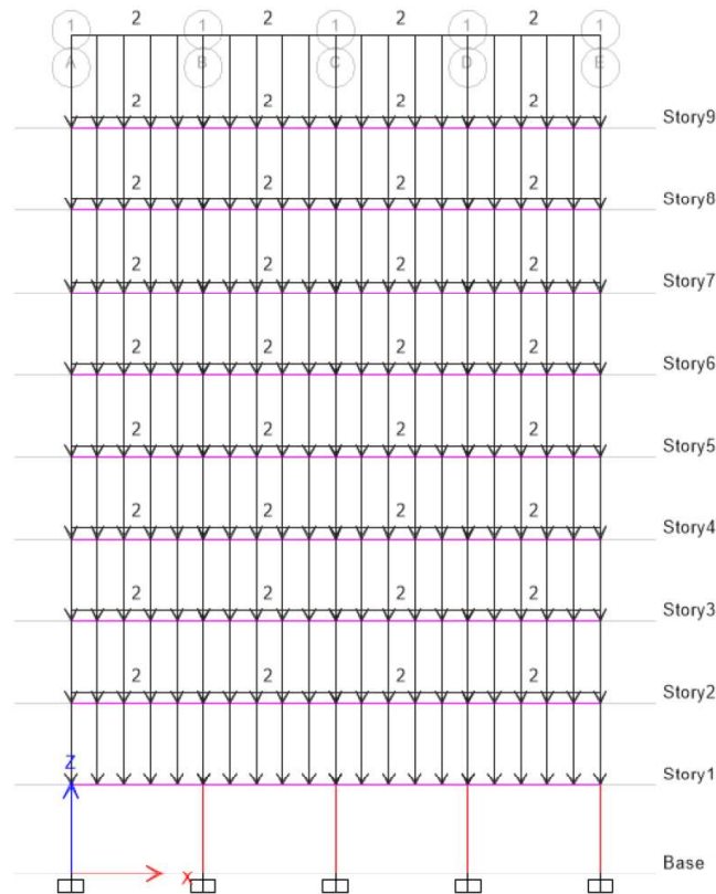
Figura 35 Asignación de carga distribuida en software comercial
