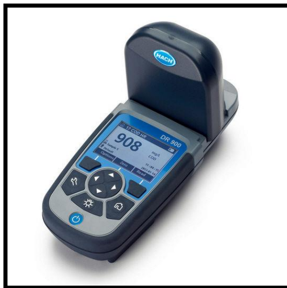
Figura N° 3: Colorímetro Hach DR 900
