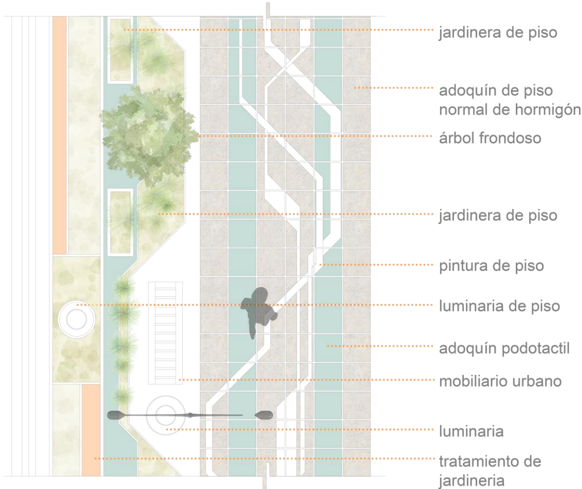
Figura 160 Tratamiento de piso de vía colectora
