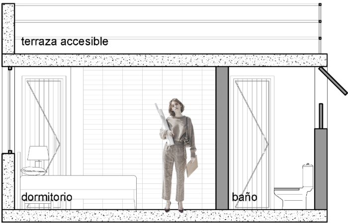
Figura 63 Iluminación y ventilación natural en dormitorio y baño
