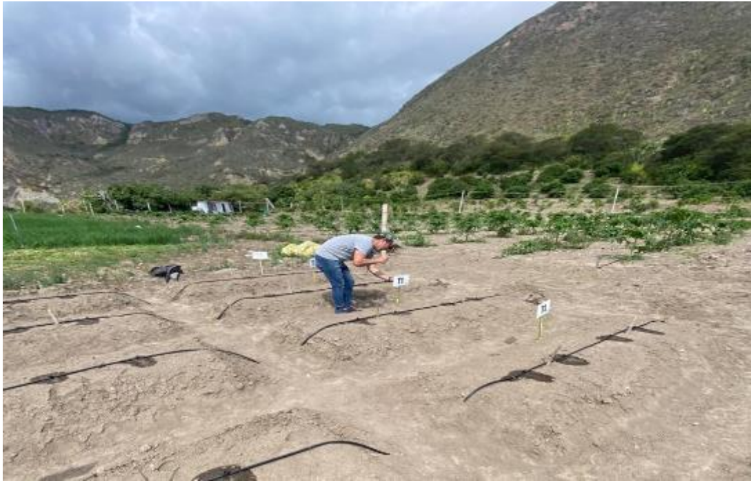
Figura 16 Comprobación de emisores del sistema de riego
