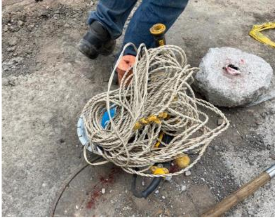
Ilustración N°5: Uso incorrecto de extensiones no certificadas Autor: Nicolas Hurtado
