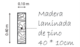
VIGA TIPO V1 ESC: 1: 50
