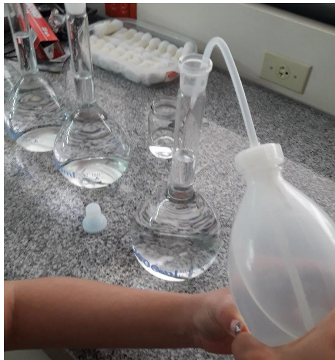
Fotografía 10: Preparación de la solución sintética de Cromo con concentración de 1 ppm. Fuente: El Autor.
