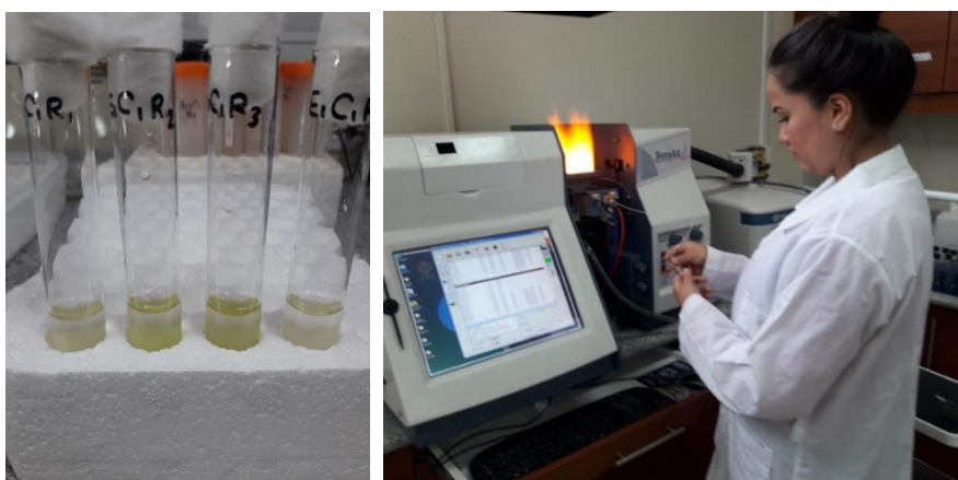
Figura 8 Análisis de laboratorio en el espectrofotómetro de absorción atómica para la determinación de la concentración de cromo.
