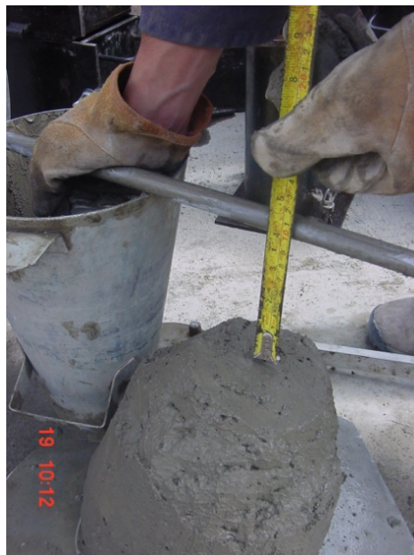
Ilustración 3.2: Medición del Asentamiento de una muestra de Hormigón con material de Pintag sin fibra RXF54 Fuente: Ensayos de Laboratorio para la investigación PUCE
