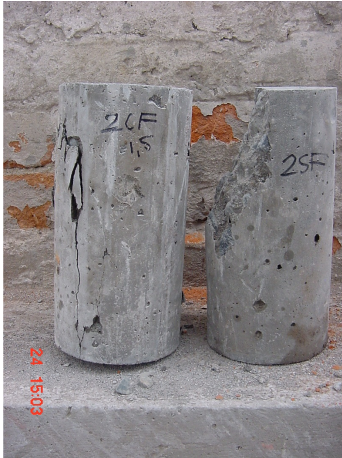
Ilustración 3: Diferencia entre un cilindro con y sin fibra después de ser ensayados, se puede notar como el cilindro sin fibra se rompe en varios pedazos mientras que el cilindro con fibra mantiene a los pedazos unidos sin explotar Elaborado por: Miguel Rivera y José Sosa
