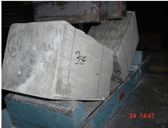
Ilustración 7.4: Ensayo de flexión a una vigueta sin fibra, cuando falla se parte en dos pedazos
