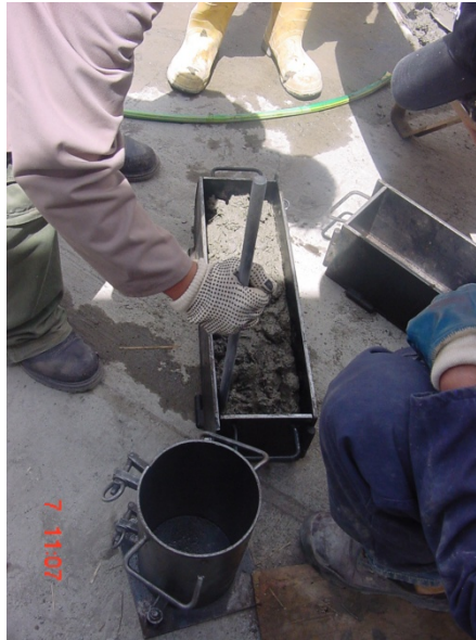
Ilustración 3.12: Moldeo de viguetas y cilindros Fuente: Ensayos de Laboratorio para la investigación PUCE
