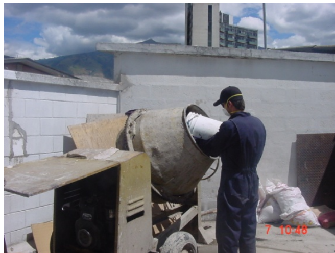
Ilustración 2.3: Colocación de las fibras disgregadas Fuente: Ensayos de Laboratorio para la investigación PUCE
