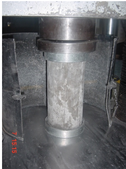
Ilustración 3.3: Ensayo de Compresión de cilindros, en el Laboratorio de la PUCE Fuente: Ensayos de Laboratorio para la investigación PUCE
