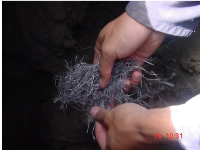
Ilustración 2.2: Disgregado de la Fibra Sintética Estructural RXF54 Fuente: Ensayos de Laboratorio para la investigación PUCE
