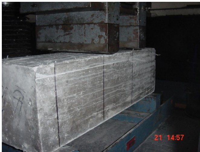
Ilustración 3.7: Ensayo de una vigueta de hormigón bajo la norma ASTM C78, dispuesta para la presente investigación Fuente: Ensayos de Laboratorio para la investigación PUCE
