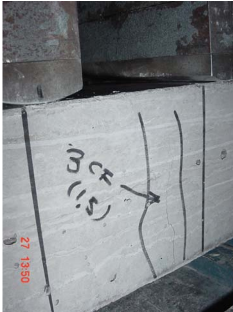
Ilustración 7.5: Ensayo de flexión a una vigueta con fibra, cuando falla la vigueta, las fibras mantienen unidas las partes del hormigón y no dejan que la fisura evolucione Fuente: Miguel Rivera y José Sosa
