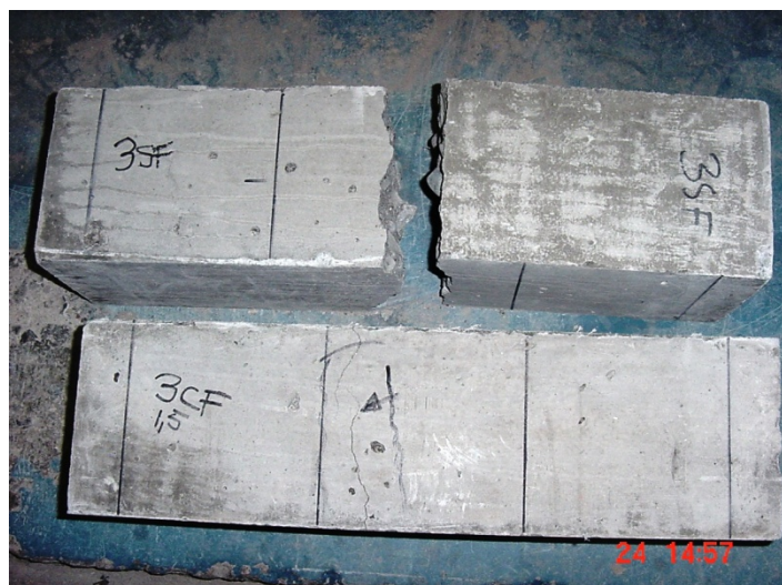
Ilustración 4: Diferencia entre una vigueta con y sin fibra después de ser ensayadas, se puede notar como la vigueta sin fibra se rompe en dos pedazos en la falla mientras que la vigueta con fibra mantiene a los dos pedazos unidos sin separarse
