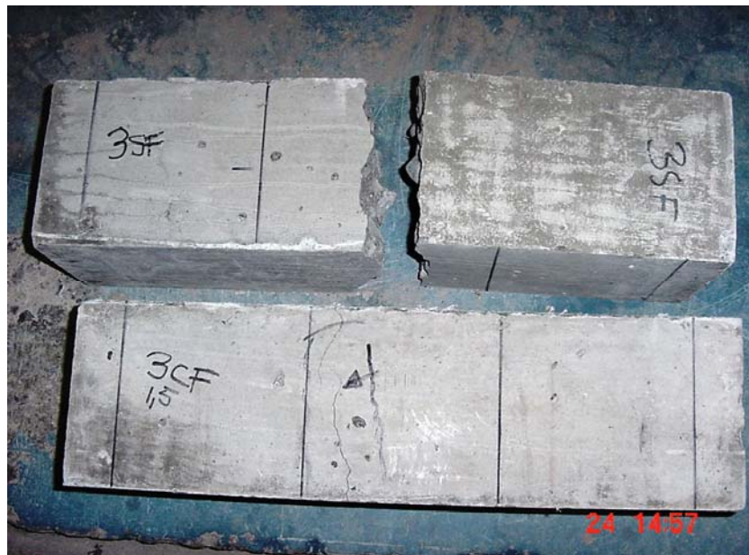
Ilustración 7.6: Diferencia entre una vigueta sin fibra y otra con fibra, las fibras mantienen unidas las secciones de hormigón que están partidas Fuente: Miguel Rivera y José Sosa
