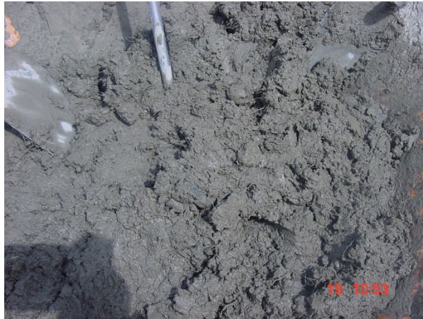
Ilustración 1.2: Hormigón con fibra RFX54 elaborado para la investigación Fuente: Ensayos de Laboratorio para la investigación PUCE
