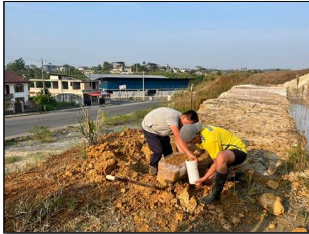
Figura 6. Recubrimiento de muestra con parafina y plástico
