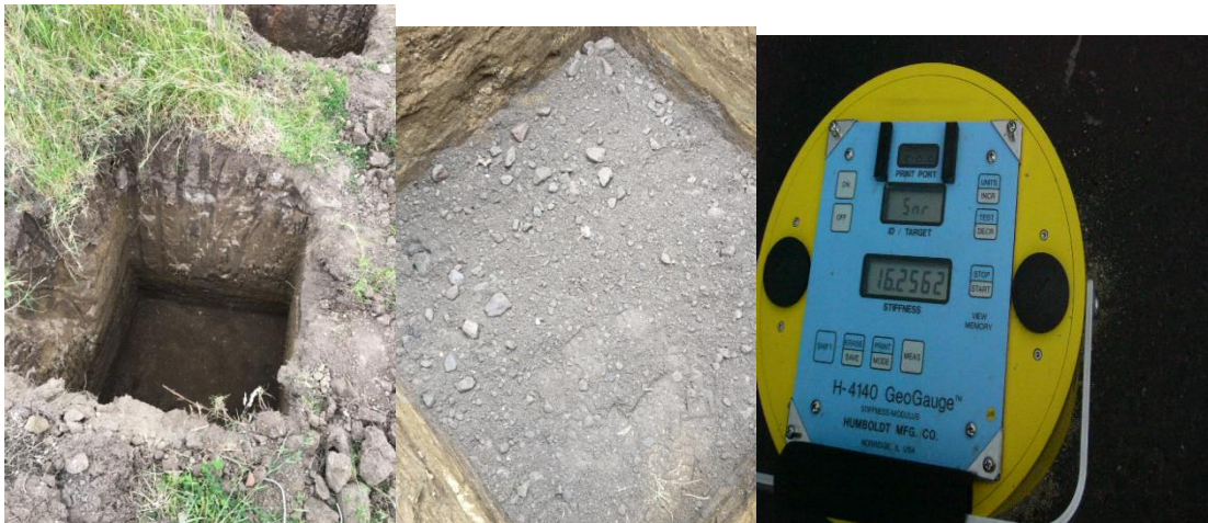
Preparación del modelo de la estructura del pavimento flexible y uso del Geogauge
