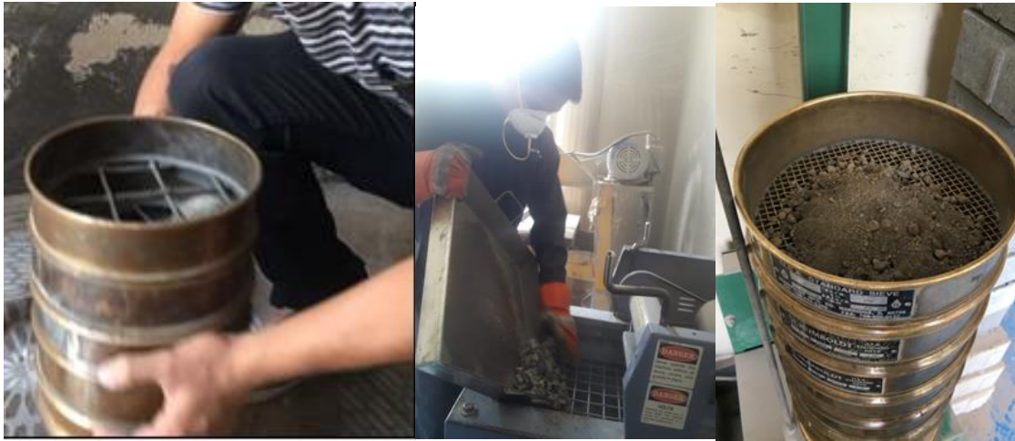
Ensayo de Granulometría Agregado Grueso y Fino.
