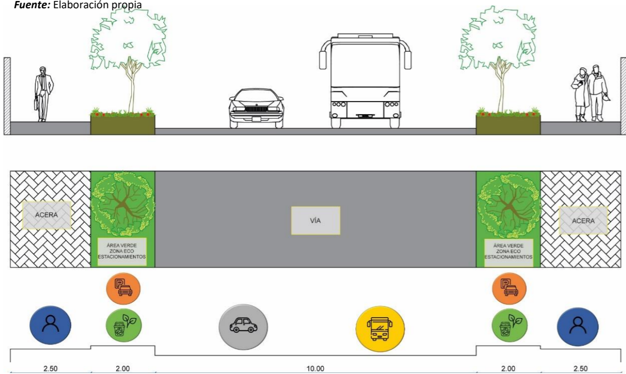
Figura 167: Corte vía local tipo 1 tramo 2
