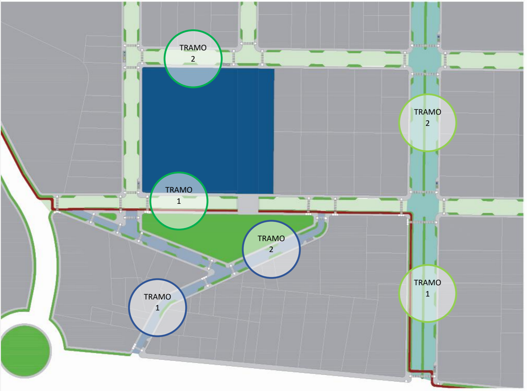
Figura 163: Diseño de vías: colectora 1-2, local 1-2
