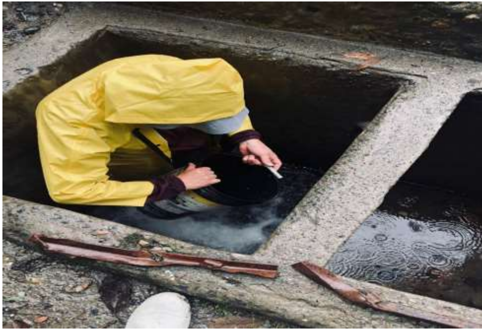
Figura 35. Método Volumétrico para Calcular el Caudal Captado
