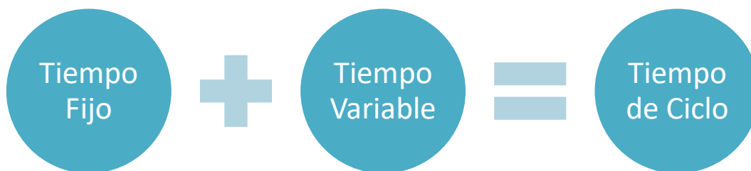
Ilustración 8. Ciclo de trabajo de una excavadora, Fuente: (Merizalde, Maquinaria de Construcción Capítulo 3, 2013).
