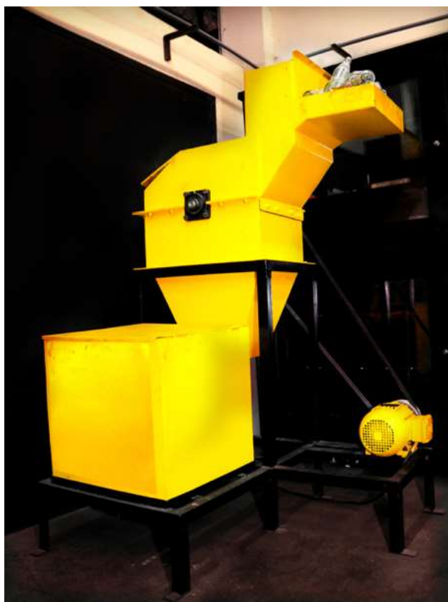
Imagen 1.3. Máquina trituradora de vidrio construida en Ecuador. Fuente: (Fajardo & Tamayo, 2011)
