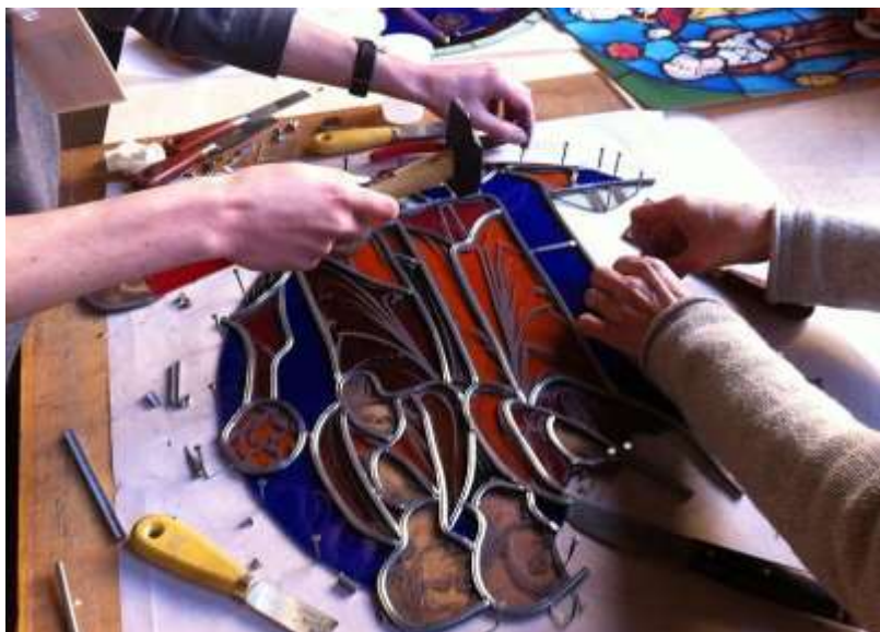
Imagen 1.12. Pegado de piezas de vidrio para un vitral. Fuente: Imagen extraída de Google Imágenes, https://bit.ly/2JWrxiC
