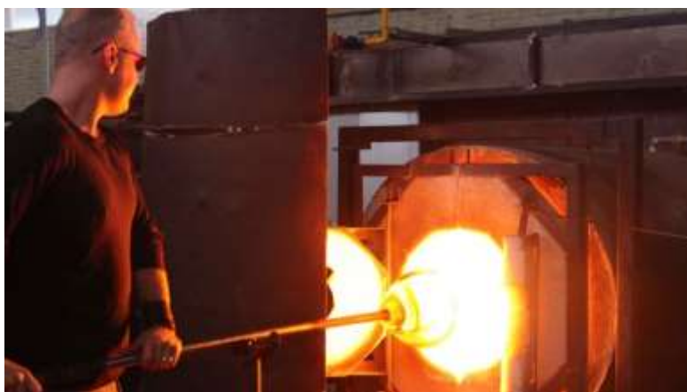
Imagen 1.8. Trabajo en horno equipado con material refractario. Fuente: Imagen extraída de Google Imágenes, https://bit.ly/2yYtbvJ
